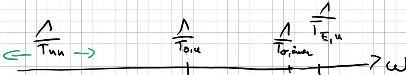
$$F_0(s) = \underbrace{V_{ru} \left( 1 + \frac{1}{s \cdot T_{n,u}} \right)}_{P_1 - \text{Regler}} \cdot \underbrace{\frac{1}{1 + s \cdot T_{o,u}}}_{\text{Erstglied Stromregelkreis}} \cdot \underbrace{\frac{1}{s \cdot T_{o,u}}}_{\text{Kondensator}}$$
